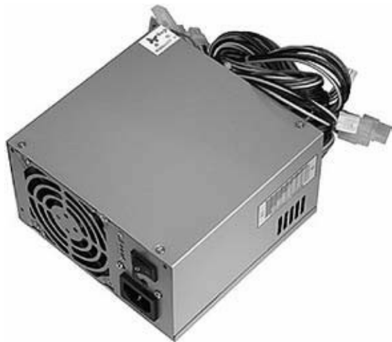
Рис. 4.13. Блок питания компьютера стандарта АТХ
