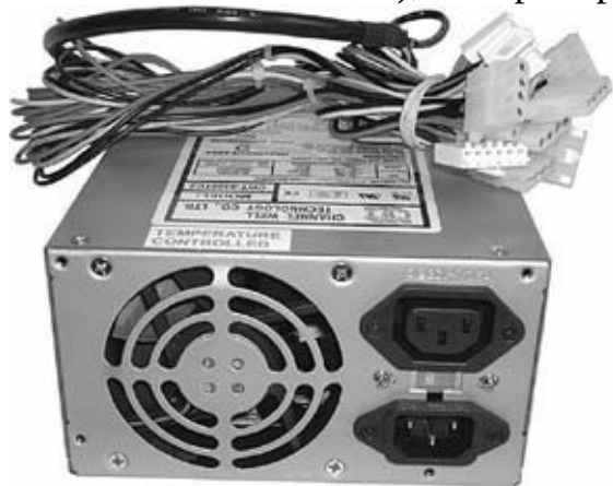
Рис. 4.14. Блок питания компьютера стандарта АТ
