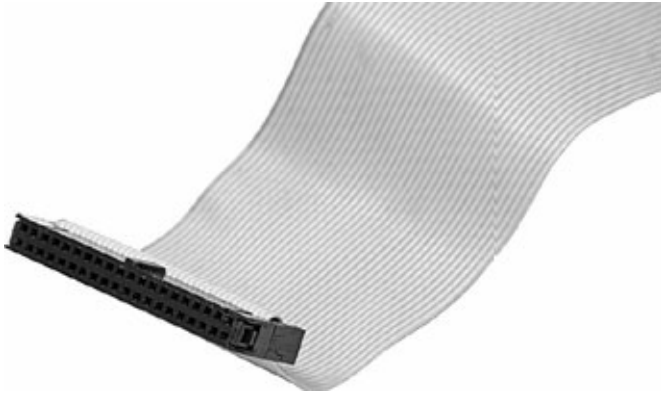
Рис. 9.3. 80-жильный кабель UltraDMA АТА
