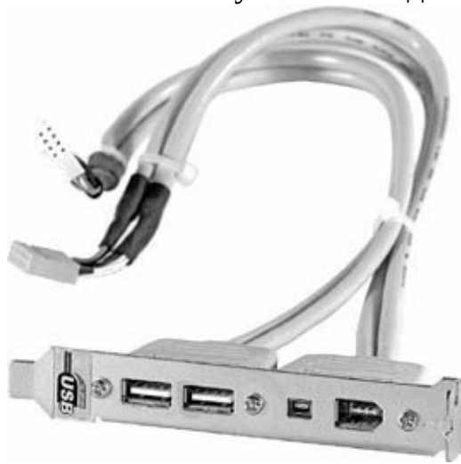
Рис. 5.16. USB-порты на внешней планке материнской платы
