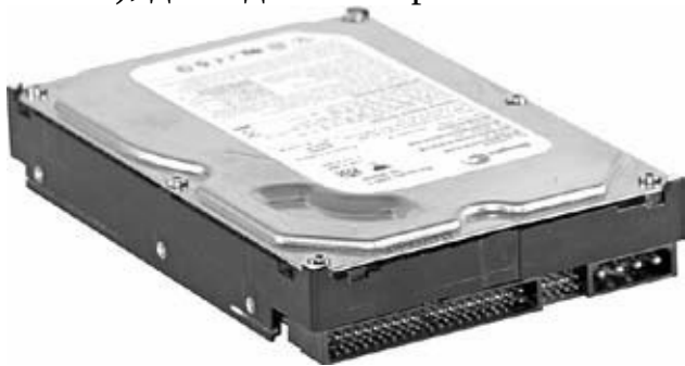
Рис. 9.2. Накопитель на жестком магнитном диске ATA
