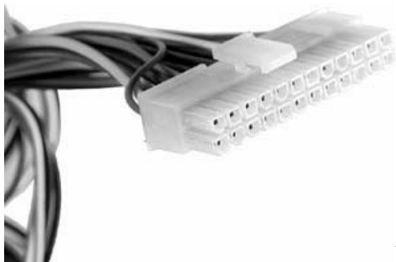
Рис. 4.17. 24-контактный разъем питания ATX
