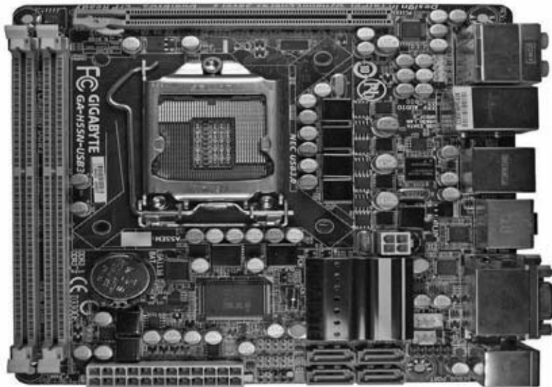
Рис. 5.9. В правой нижней части на снимке расположены четыре разъема для подключения SATA-устройств
