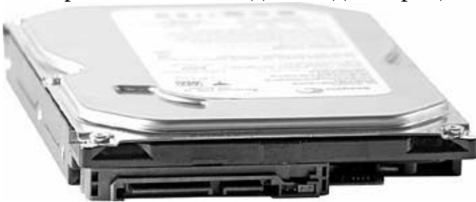
Рис. 9.1. Накопитель на жестком магнитном диске SATA
