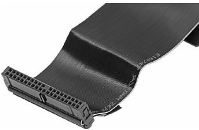
Рис. 9.3. 80-жильный кабель UltraDMA АТА
