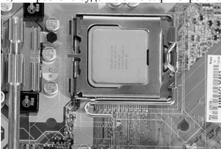
Рис. 7.8. Установите процессор в сокет
