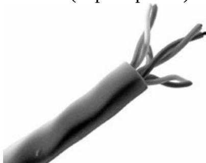
Рис. 13.3. Неэкранированная витая пара
