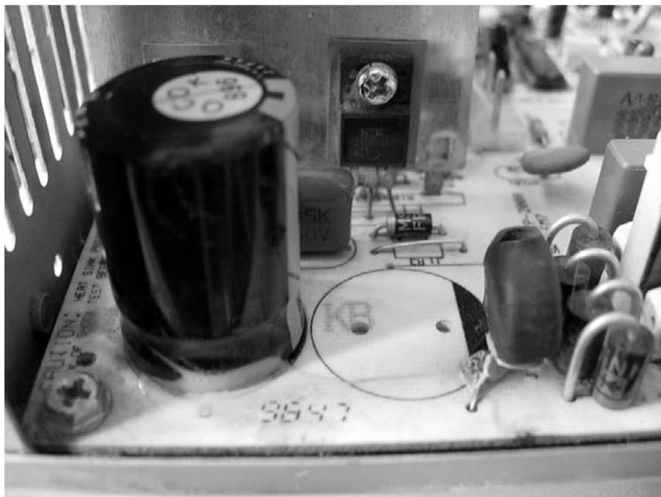
Рис. 22.5. Конденсатор высоковольтного фильтра. Обратите внимание — второй конденсатор отсутствует
