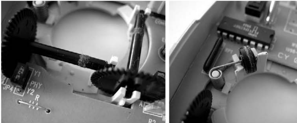
Рис. 14.2. Очищаем валики (слева) и прижимной вал (справа) от прилипшей грязи
