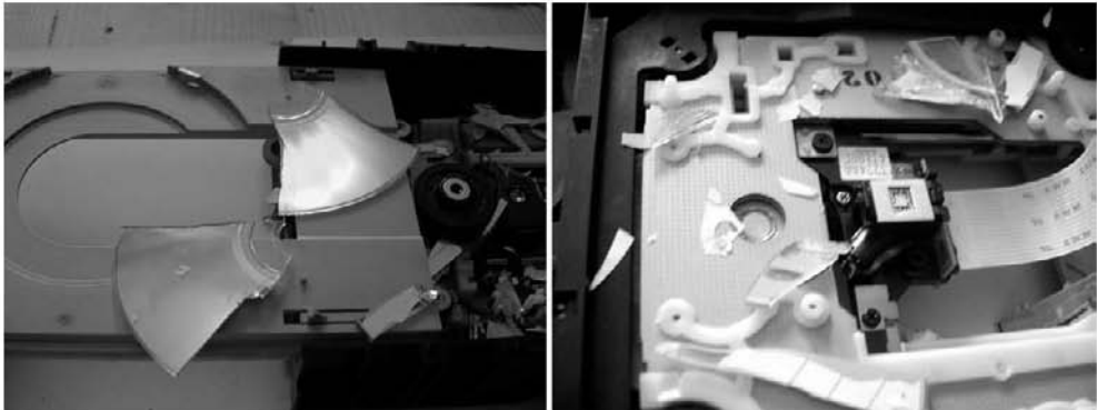
Рис. 23.5. Освобождаем привод от обломков диска
